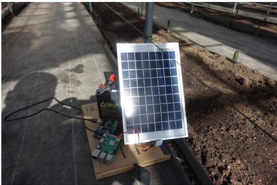
ソーラパネルとバッテリーの組み込み
